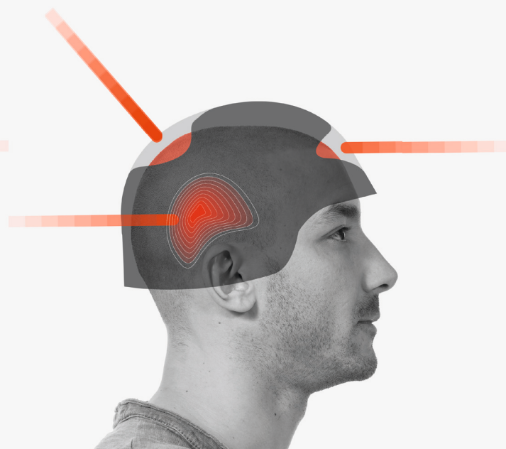
Casco de aramida/PE Penetración con >25 Joule
